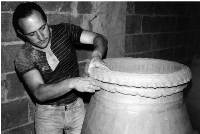
Juan Francisco rematando la boca y el labio, final de la operación de embocar. .
