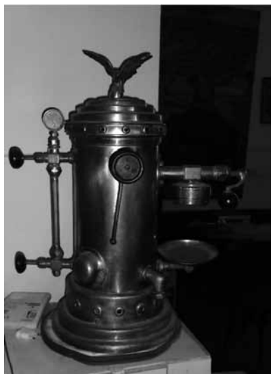
Fig. 6: Máquina cafetera Express de caldera con capacidad de 15 litros, con dos brazos de dos tazas a gasolina, nº423. Adquirida por Rafael Terrén Pérez a la empresa Mans y Oms (Barcelona) el 13 de marzo de 1936 a un precio de 2.230 pesetas.
